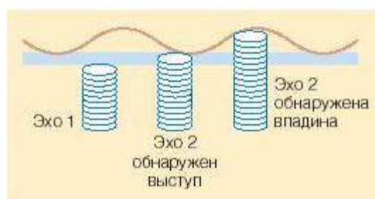
Рис. 8. Принцип работы ультразвукового сканера
