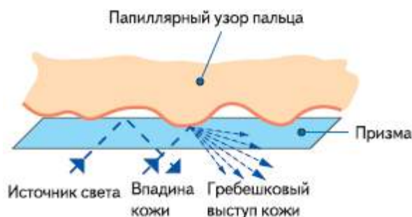
Рис. 1. Принцип работы FTIR-сканера
